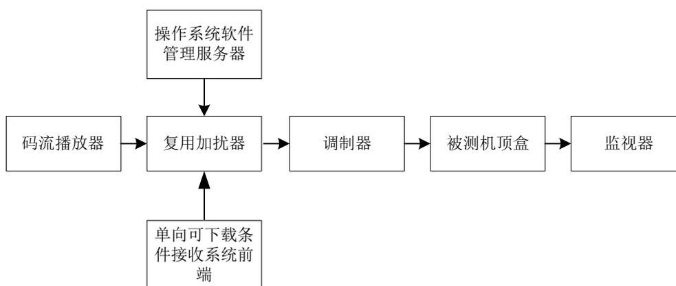
图5 单向可下载条件接收测量框图
