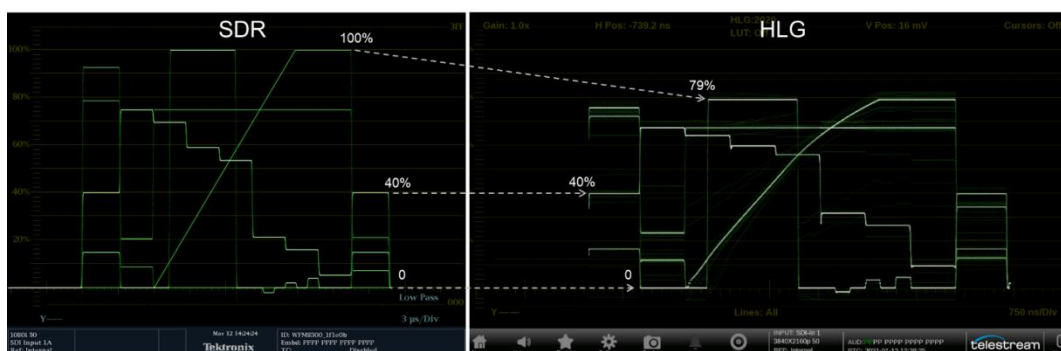
图 B.4 SDR-HLG 上转换 LUT 映射关系（输入 RP219 高清彩条）
